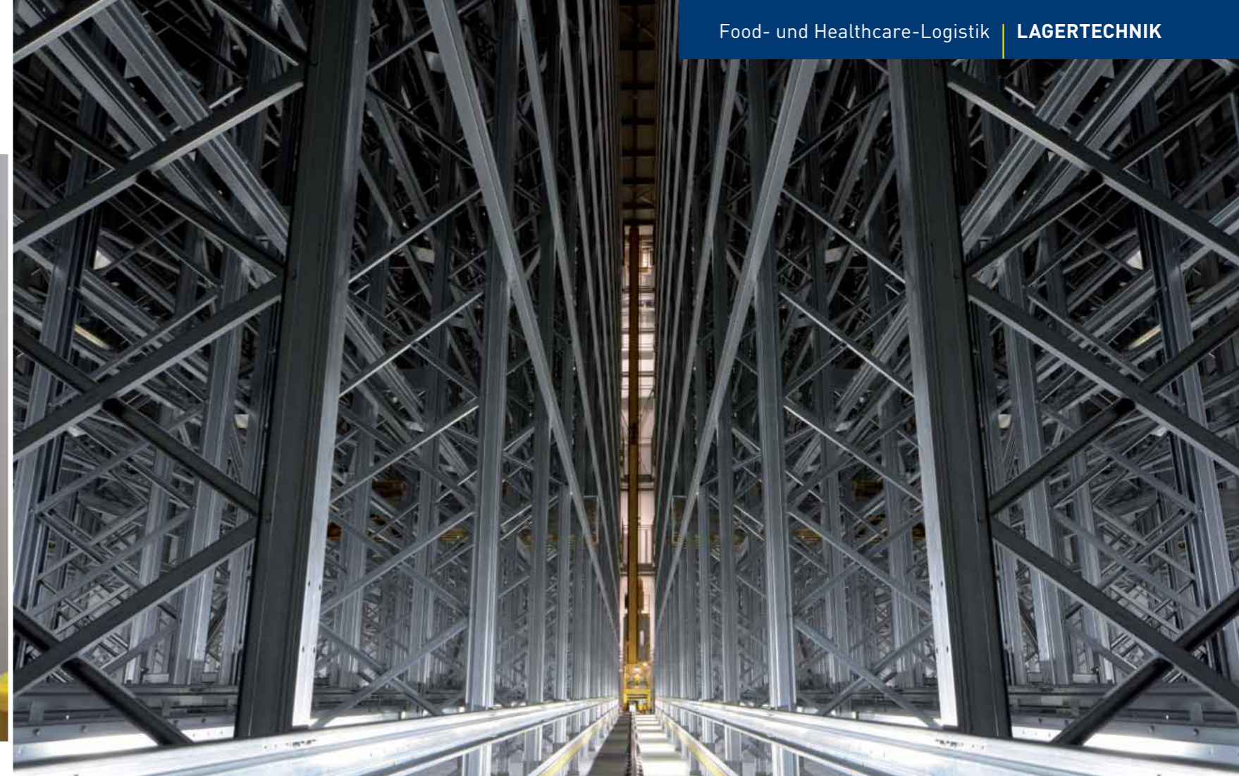
3 Im Tiefkühl-Hochregallagerverfahren vier Regalbediengeräte mit einer Leistung von bis zu 22 Doppelspielen pro Stunde.
