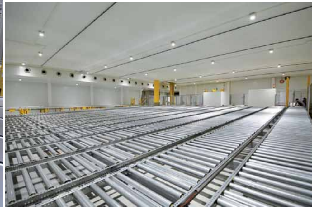
6 Die auszuliefernden Paletten werden auf neuartige, speziell für den TK-Bereich konzipierte Schwerkraftrollbahnen bereitgestellt.
