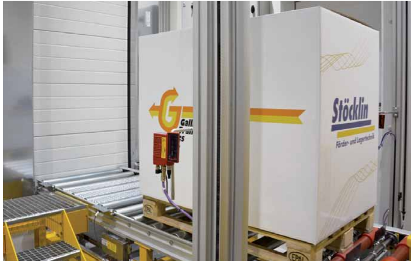
1 Im Wareneingang werden die angelieferten Paletten auf Rollenbahnen aufgesetzt und einem Profilkontrollplatz mit fest installierten Scannern zugeführt.
